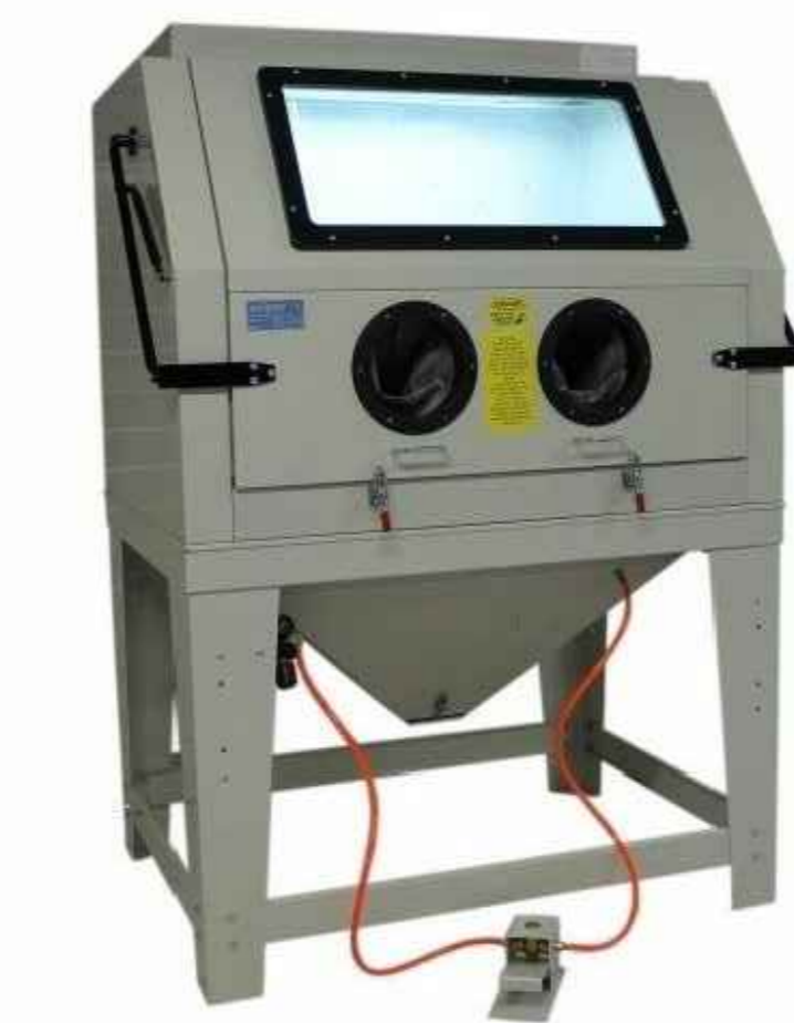
Cabina sabbatrice tipo SOGI S-72 La sabbatrice è in grado di sabbare, pulire e satinare le superfici metalliche, tramite un flusso in pressione di particelle abrasive secche, come microsfere di vetro o corindone. Nella lavorazione può presentare diversi gradi di finitura, variando la granulometria delle particelle abrasive e del tipo di particolari da lavorare, come pezzi in legno, motori, pezzi meccanici e altri metalli, plastiche etc. Il pannello frontale in vetro consente la verifica del proprio operato attraverso lo schermo posto sopra la macchina con impianto di illuminazione. Per introdurre il pezzo da lavorare in questo modello basta sollevare la parte superiore attuata da due ammortizzatori a gas. Dotata di filtro aspirazione con predisposizione per aspiratore.
