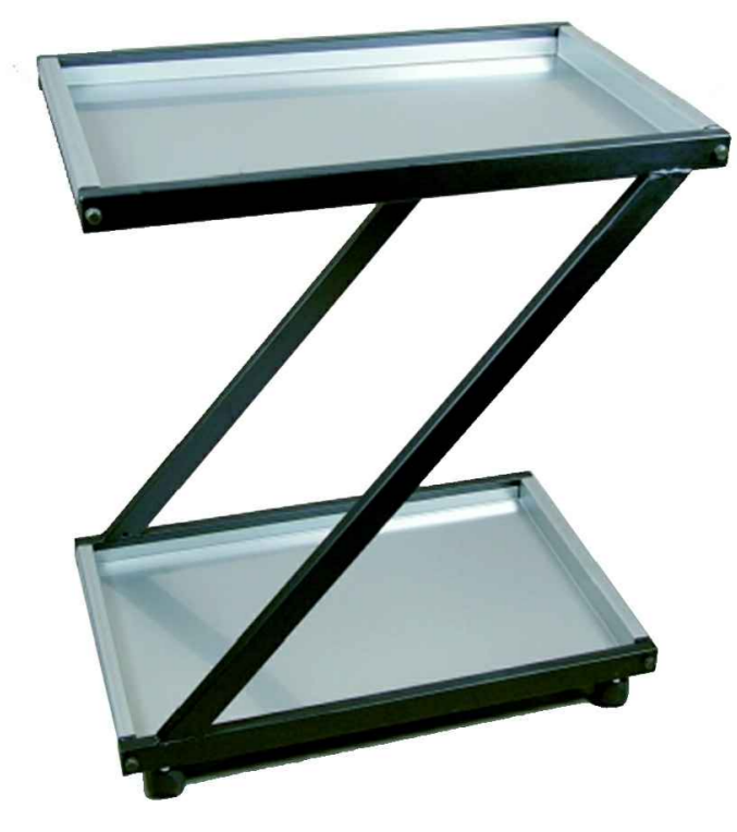
Carrello da laboratorio dim. 710x450xh. 800 mm acciaio verniciato a forno con polveri epossidiche, con due ripiani in acciaio inox asportabili, scorrevole su ruote girevoli. - Peso 17,5 kg.
